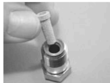
Рис. 3b – Установка нового конического фильтра
