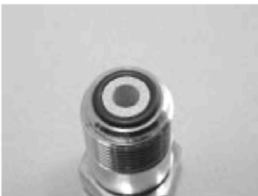
Рис. 3c – Установка уплотнительного кольца фильтра
