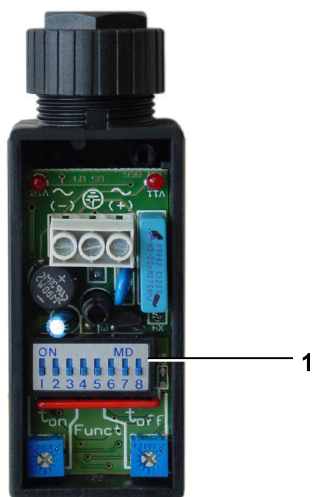
Рис. 50 Реле времени K10 (бензиновый двигатель; Bürkert)
