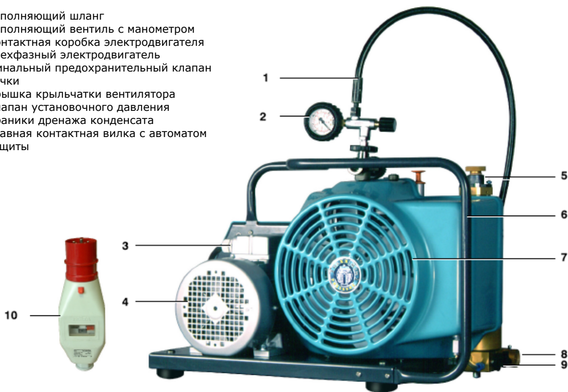
Рис. 4. Компрессор с трехфазным электродвигателем
