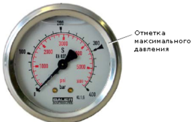
Рис.33. Манометр финального давления
