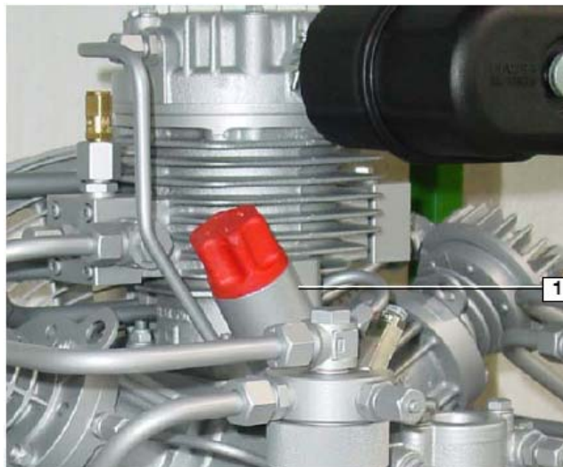
Рис.21. Заливная горловина масляной системы
