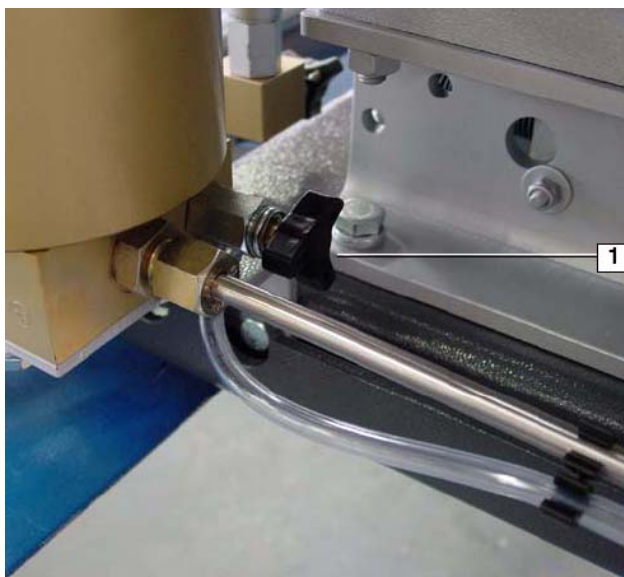
Рис.39. Краник сброса конденсата финального сепаратора (фильтрующая система P31)
