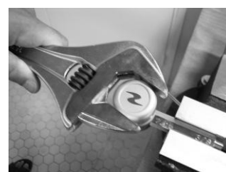
6. Закрепите первую ступень регулятора в тиски так, чтобы фирменная наклейка Aqualung была сверху. Выкрутите крышку корпуса (2), используя регулировочный гаечный ключ. Вытащите пружину и блок, состоящий из крышки корпуса (2) и поршня(4). Извлеките первую ступень из тисков.
