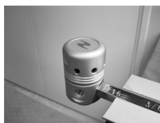
6. Закрепите первую ступень регулятора в тиски так, чтобы фирменная наклейка Aqualung была сверху. Выкрутите крышку корпуса (2), используя регулировочный гаечный ключ. Вытащите пружину и блок, состоящий из крышки корпуса (2) и поршня(4). Извлеките первую ступень из тисков.
