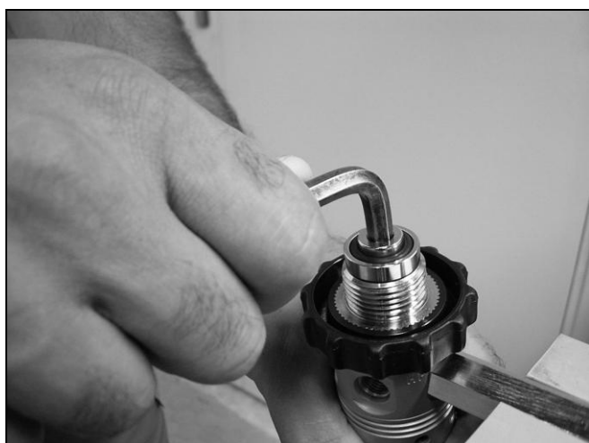
4.1 Раскрутите штуцер DIN или Нитрокс, используя ключ-шестигранник на 6 мм.
