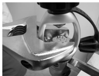
5.1 Раскрутите крепежную гайку струбины, используя большой регулировочный ключ, снимите проставку (12).
