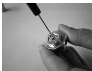
5.3 Используя специальное приспособление (номер: 116236), извлеките из седла конический фильтр, а затем снимите уплотнительное кольцо (9) с его желобка.
