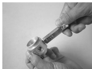
6. Закрепите первую ступень регулятора в тиски так, чтобы фирменная наклейка Aqualung была сверху. Выкрутите крышку корпуса (2), используя регулировочный гаечный ключ. Вытащите пружину и блок, состоящий из крышки корпуса (2) и поршня(4). Извлеките первую ступень из тисков.
