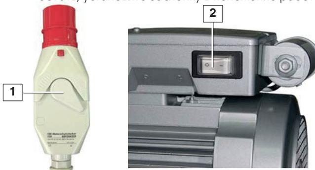
Рис. 6 Защитный выключатель двигателя
