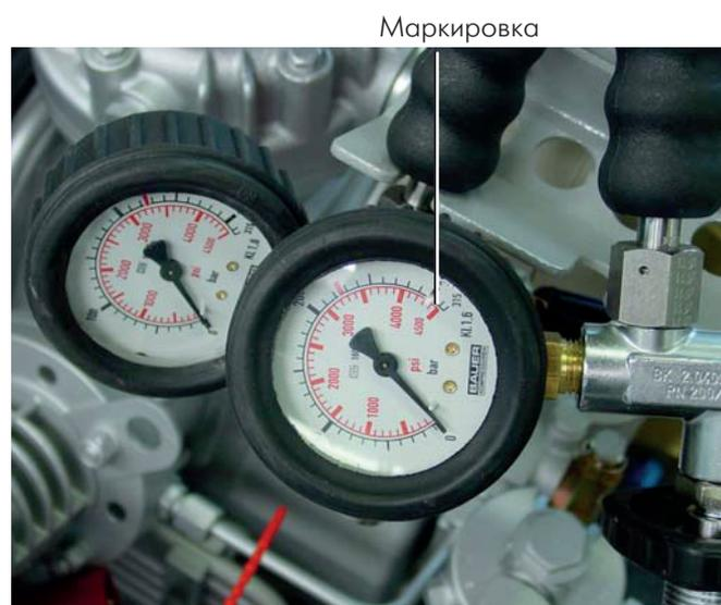
Рис. 23 Выпуск воздуха из предохранительного клапана конечного давления
