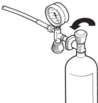
Рис. 9 Присоединение баллона сжатого воздуха
