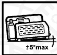
Горизонтальное положение компрессора: максимальный угол наклона не более 5°
