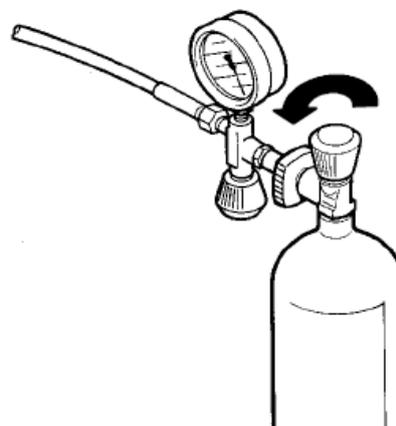
Рис.6. Подсоединение баллона
