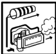
Компрессор с бензиновым двигателем должен быть установлен выхлопом ПО ВЕТРУ, во избежание всасывания выхлопных газов в компрессор
