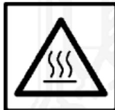
Остерегайтесь горячих поверхностей компрессорного блока и двигателя.
